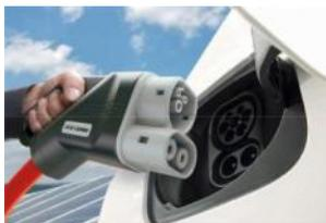
Au niveau de la carrosserie, un ou deux **connecteurs électriques** permettent de recharger la batterie de traction, sans risque d'électrocution. Lors du branchement, un courant 12 V de faible Intensité circule pendant quelques secondes entre la borne de recharge et la voiture. Il sert à déterminer la puissance maximum provenant de la borne.
