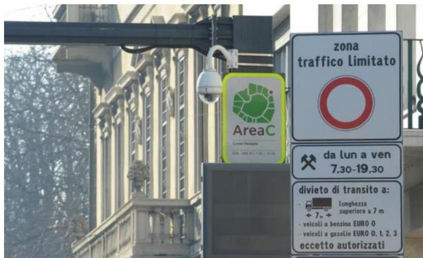
Figure 54 : Panneau d'entrée de l'Area C (ZTL) de Milan avec caméra ANPR
