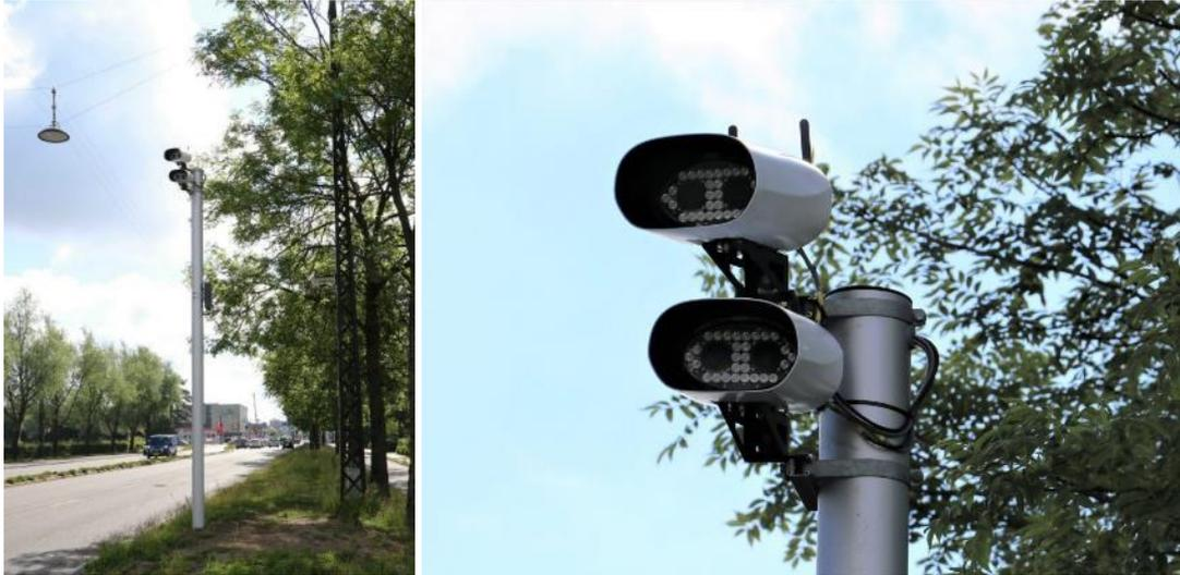
Figure 48 : Exemple de caméras ANPR installées à différents points de contrôle dans chaque LEZ
