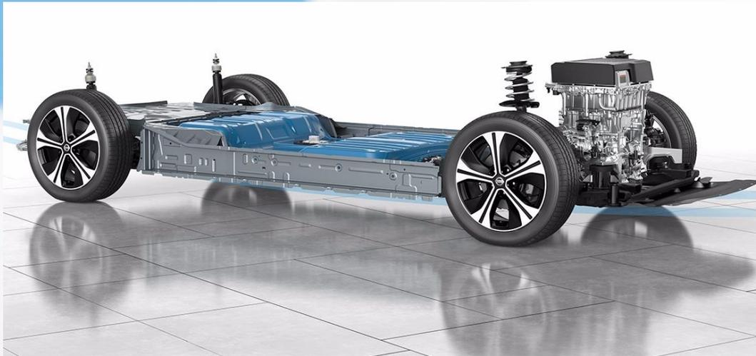
Le **châssis** est conçu pour recevoir et protéger la batterie, tout en assurant la rigidité de l'ensemble.
